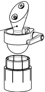
Fixierung mit Klemmhebel, dadurch von Hand verstellbar
