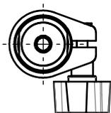
Kugelfixierung mit Flügelschraube
